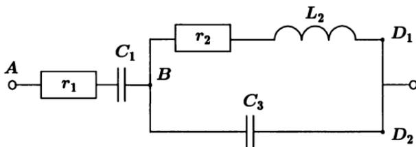
Пусть  $r_1 = 5$  Ом,  $r_{c_1} = 15$  Ом,  $r_2 = 12$  Ом,  $r_{l_2} = 16$  Ом,  $r_{c_3} = 10$  Ом. Необходимо найти сопротивление всей цепи.
